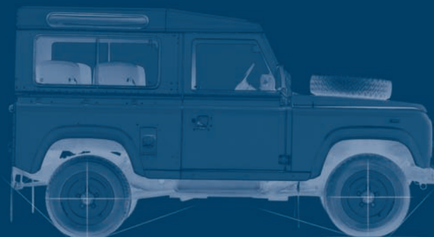
'90' Station Wagon (1984-1990) 1984 – listové pružiny byly nahrazeny vinutými pružinami. Novinkou bylo jednoduché čelní sklo. Přední boční spouštěcí okna nahradila posuvná okna. Vzhledem k širšímu rozchodu kol byly použity polyuretanové podběhy.
