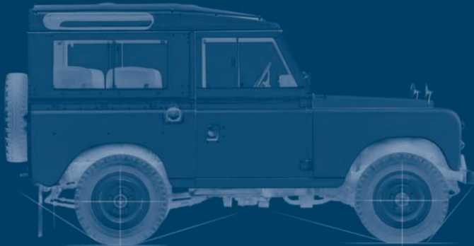
Série III Station Wagon (1972-1984) 1972 – do blatníku bylo přidáno sání vzduchu pro topení. 1981 – vylepšené sedačky u modelu County.
